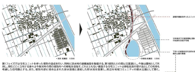
第1フェーズでは住宅ユニットを併せた堤防の造成を行い、同時に洪水時の避難施設を整備する。第1堤防と川の間は氾濫地とし、今後は農地として利用し、現にここに立地する家々を今後30年の間の堤防への移転を目指す。これにともない建造する住宅ユニットは移転住民の受け皿としての利用も考慮した住宅数とする。また、堤防内部に埋め込まれた排水設備と連結した貯水池を設置し、周辺を地域コミュニティの親水公園として開く。
